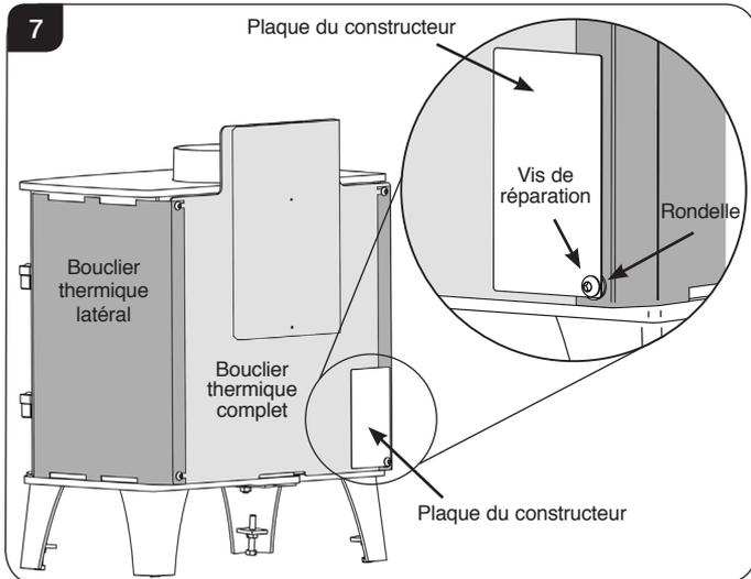
L'avant du bouclier repose sur le côté de l'appareil.
